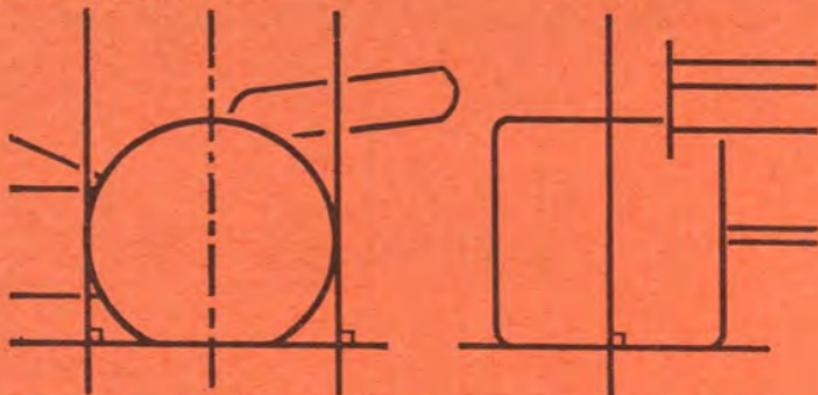
**Dessin No 15:** Art 3.5—Détermination de l'axe d'une roue.
