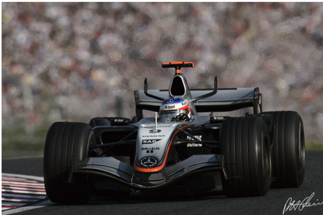
Figure 6-69 : Les cornes de la McLaren MP4-20 de 2005 (Photo PH Cahier)
