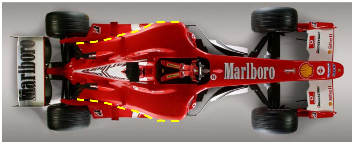
Figure 2-18 : La forme de bouteille de Coke (pointillé jaune)
