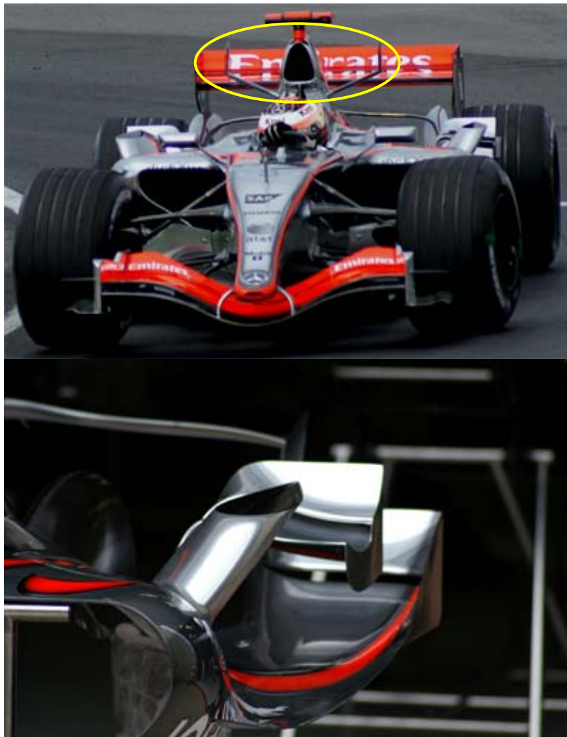
Figure 2-13 : Winglets et ailettes sur la McLaren MP4-21 de 2006 (Photos Auteur)
