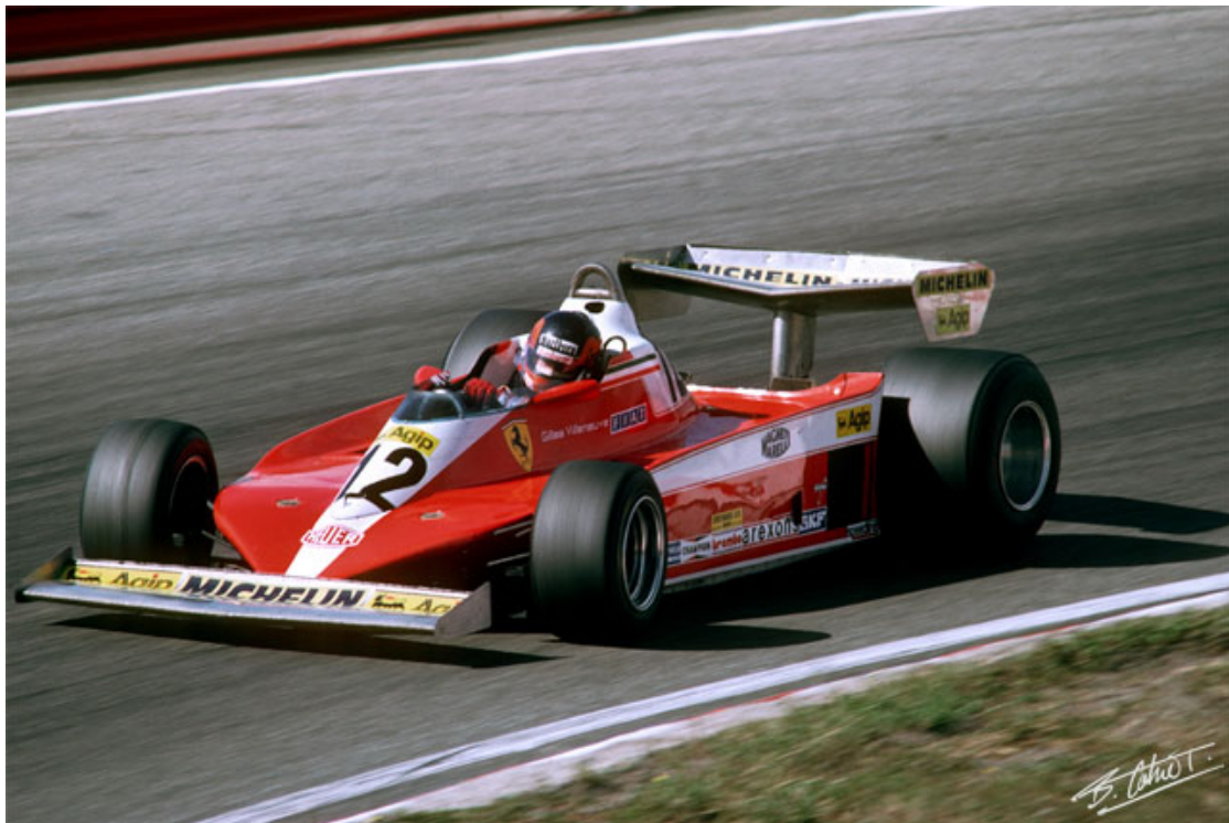
Figure 6-90 : Aileron arrière monté sur pilier central - Ferrari 312T3 de 1978 (Photo Bernard Cahier)
