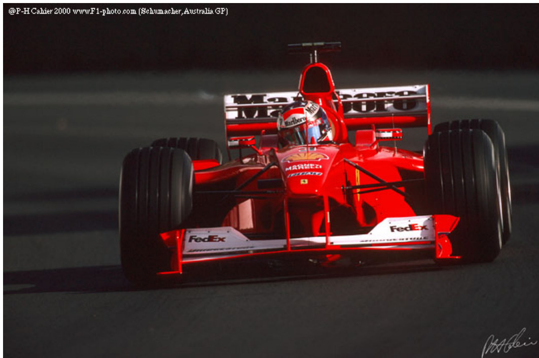
Figure 6-28 : Le concept de simple quille mis en œuvre sur la Ferrari F2000 (Photo Paul-Henri Cahier)
