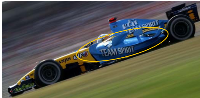
Figure 2-9 : Les pontons plongeant en partie arrière sur la Renault R26 de 2006
