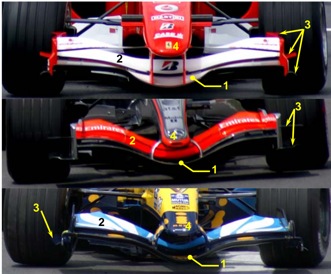
Figure 2-1 : Les éléments d'un aileron avant de F1 (Photos Auteur)
