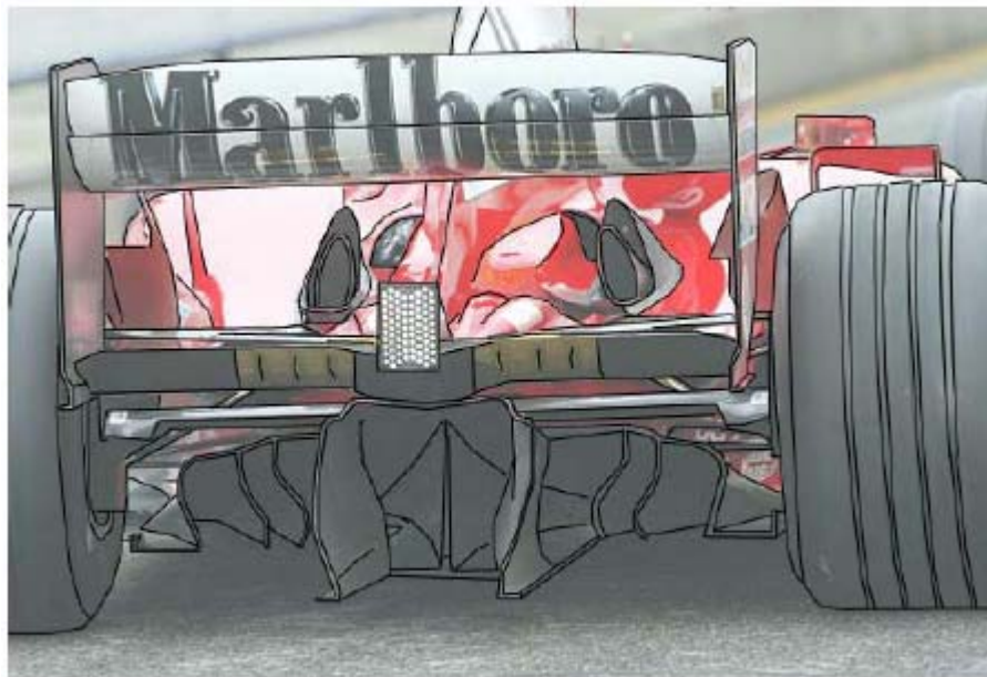
Figure 3-22 : Vue arrière de la Ferrari F2004 illustrant la conception très complexe du diffuseur
