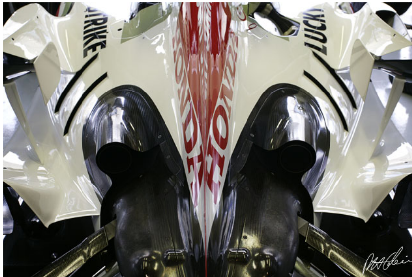
Figure 6-107 : L'échappement haut de la Honda RA106 de 2006 (Photo Paul-Henri Cahier)
