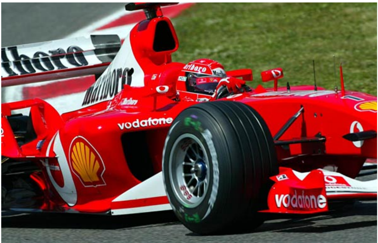
Figure 6-66 : Les pontons biseautés de la Ferrari F2003-6A de 2003
