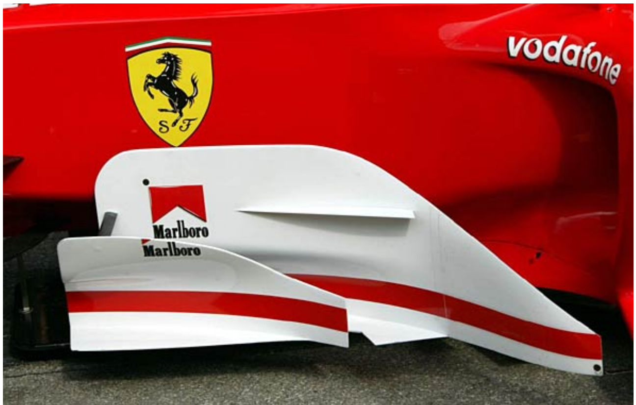
Figure 6-67 : Le concept de double déflecteur de la Ferrari F2003-GA de 2003
