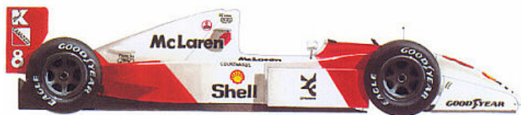
Figure 2-15 : Les premiers déflecteurs sur la McLaren MP4-8 (Dessin F1-Legend.com)
