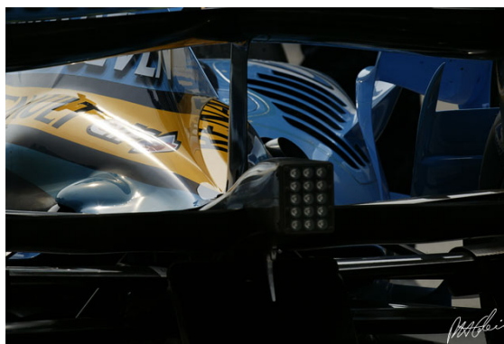
Figure 2-11 : Les ouïes sur les pontons de la Renault R26 de 2006 (Photo Paul-Henri Cahier)
