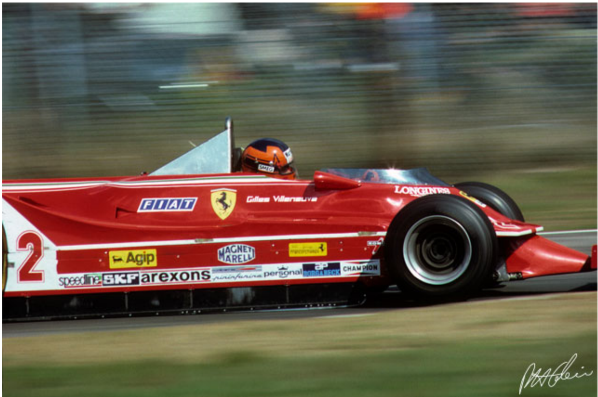
Figure 6-49 : La Ferrari 312T4 de 1980 équipée de ses jupes latérales (Photo Pierre-Henri Cahier)
