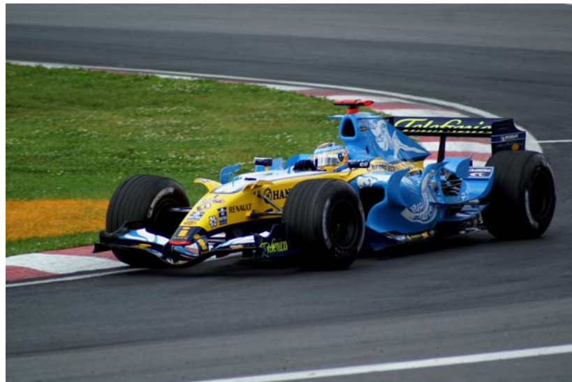
Figure 6-105 : Les flaps et dérives de la Renault R26 de 2006 (Photo Auteur)
