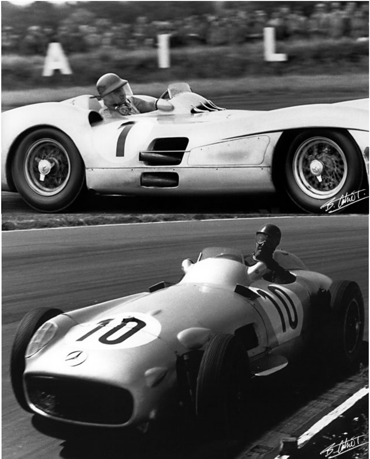
Figure 6-77 : La Mercedes W196 dans une version sans carrosserie enveloppante (Photo B. Cahier)
