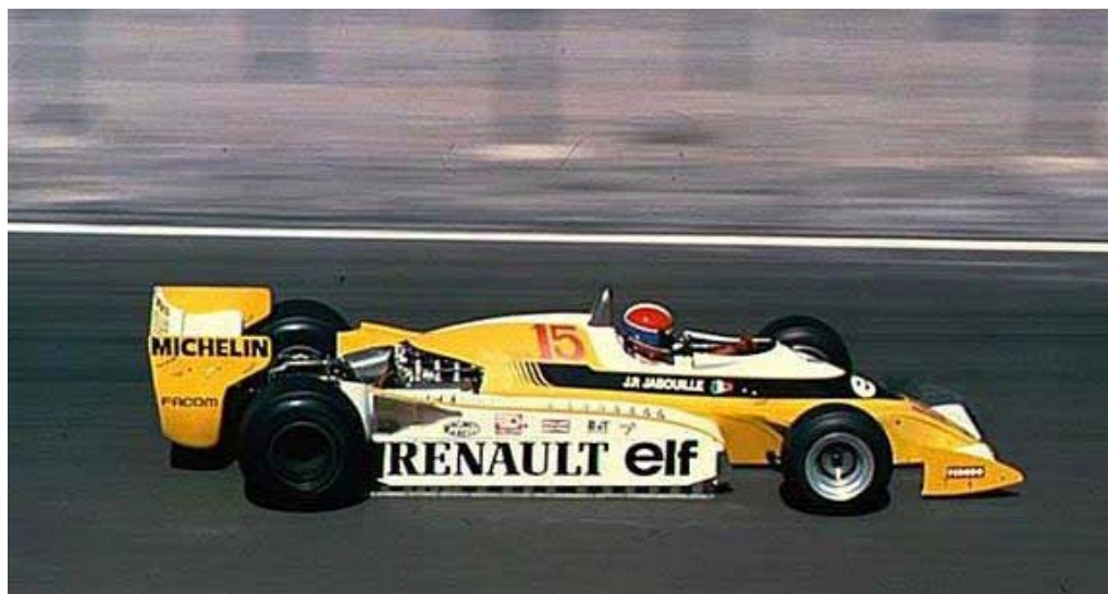
Figure 6-48 : La Renault RS10 de 1979 équipée de ses jupes latérales
