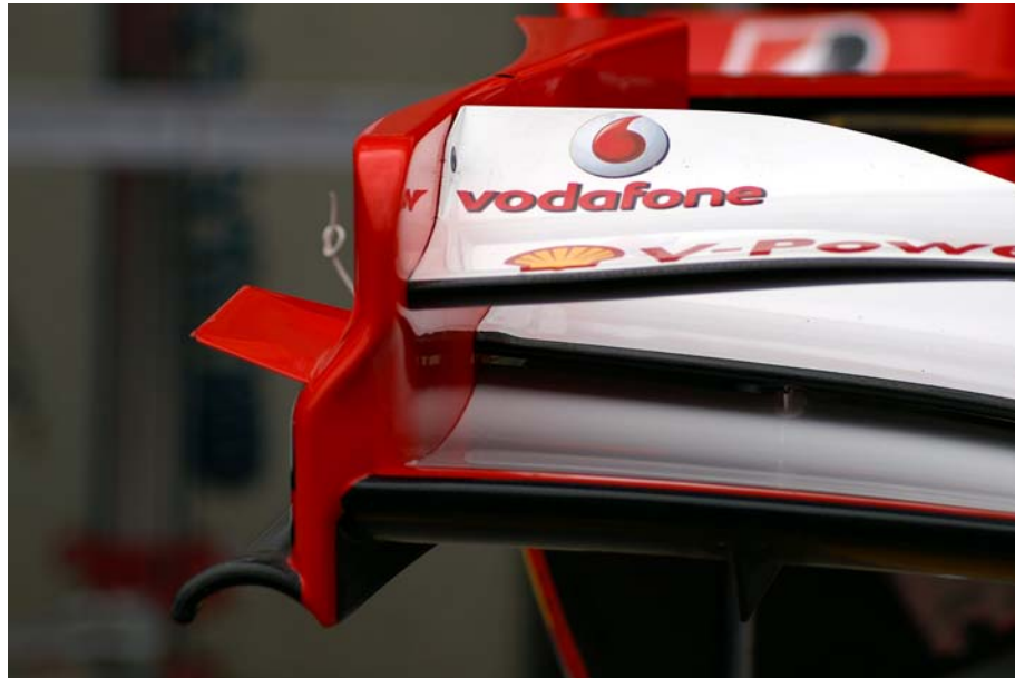
Figure 2-4 : ailettes sur l'aileron avant de la Ferrari F248-F1 de 2006 (photo Auteur)
