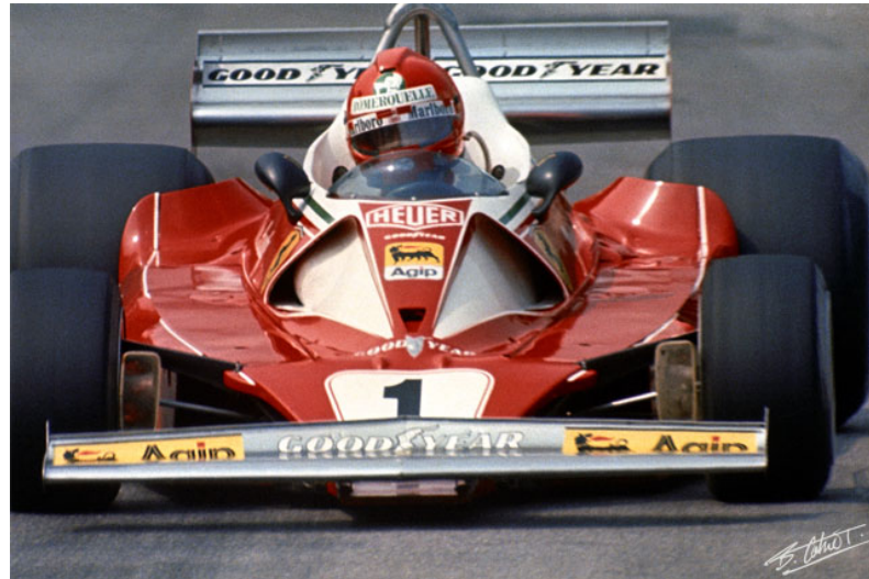
Figure 6-17 : La célèbre Ferrari 312T2 de 1976 et ses énormes prises d'air(Photo Bernard Cahier)
