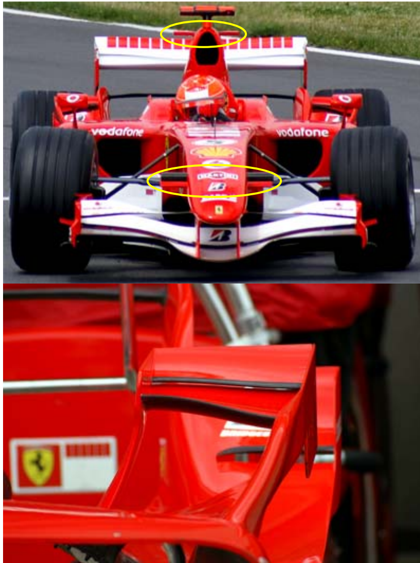
Figure 2-14 : Winglets et ailettes sur la Ferrari F248-F1 de 2006 (Photos Auteur)
