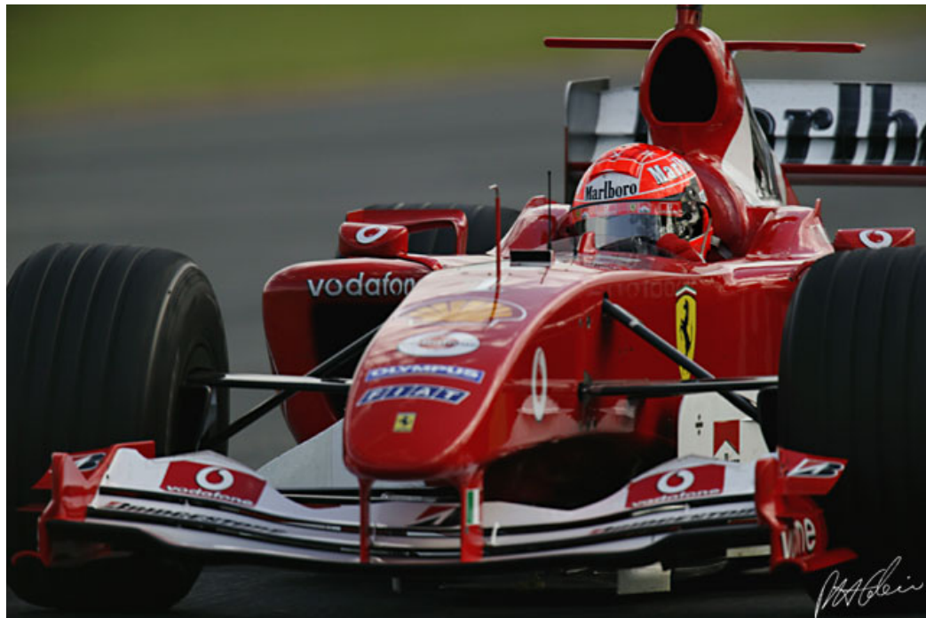
Figure 6-68 : Le concept d'aileron supérieur sur la Ferrari F2004 (Photo PH Cahier)
