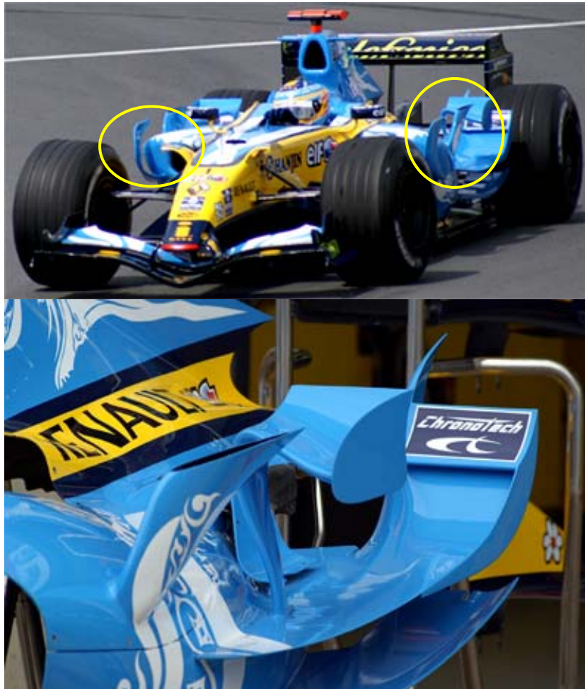
Figure 2-12 : Winglets et ailettes sur la Renault R26 de 2006 (Photos Auteur)
