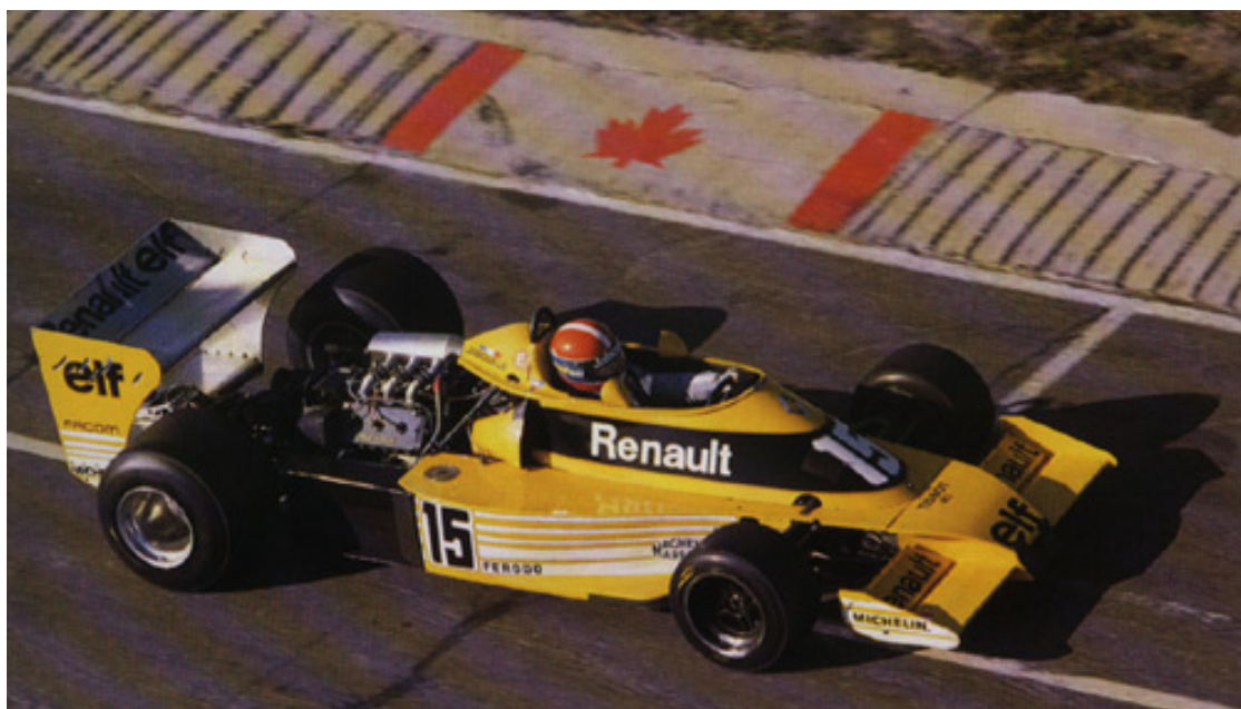
Figure 6-91 : Aileron arrière surdimensionné sur la Renault RS01 de 1977
